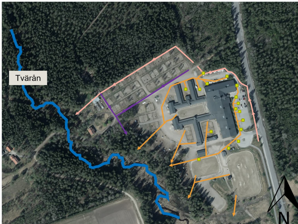
Figur 13. Delar av dagvattenledningsnätet (orange streck) och befintliga dagvattenbrunnar (ljusgröna fyrkanter). Det dike som rinner längs privathästhagarnas norra kant visas i rosa och de diken som avvattnas flertalet privathästhagar redovisas i lila. (Lantmäteriet, 2023)
